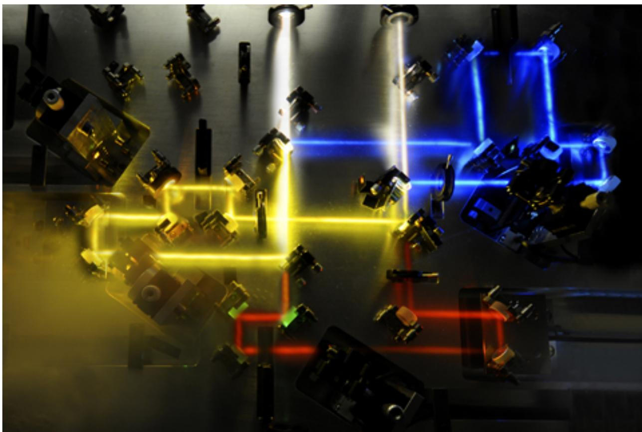
Ein Lichtwellensynthesator spaltet einfallendes weißes Laserlicht in drei Farbkanäle auf und modifiziert es anschließend. Das Zusammensetzen erzeugt Laserpulse mit komplexen, aber fein justierbaren Wellenverläufen.
