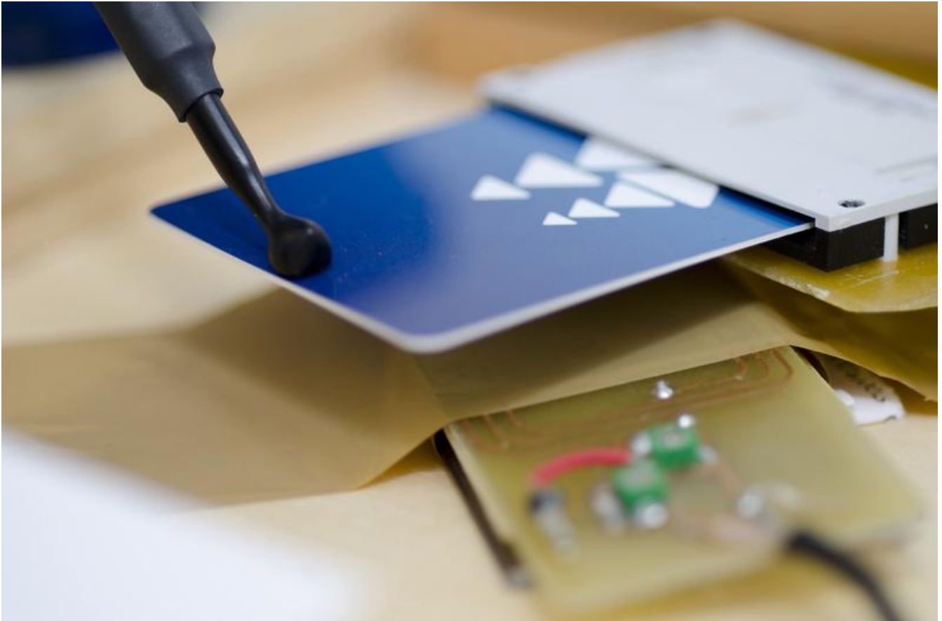
Smartcard: Messung des elektro-magnetischen Feldes
