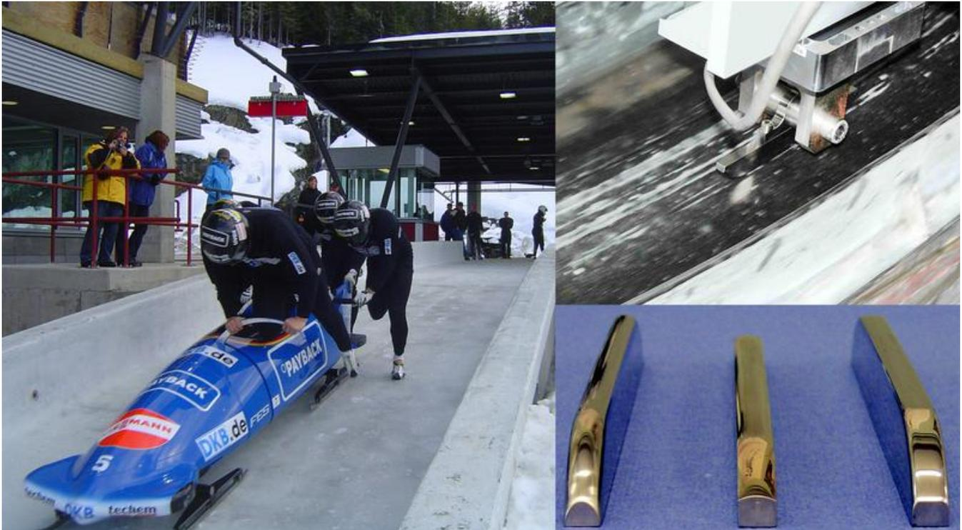
Die Reibungswerte von Kufen lassen sich nun genau bestimmen: rechts oben der Messaufbau mit Kufe und Sensor im Eiskanal, rechts unten verschiedene Kufentypen: (von links nach rechts) Bob, Skeleton und Rodel.
