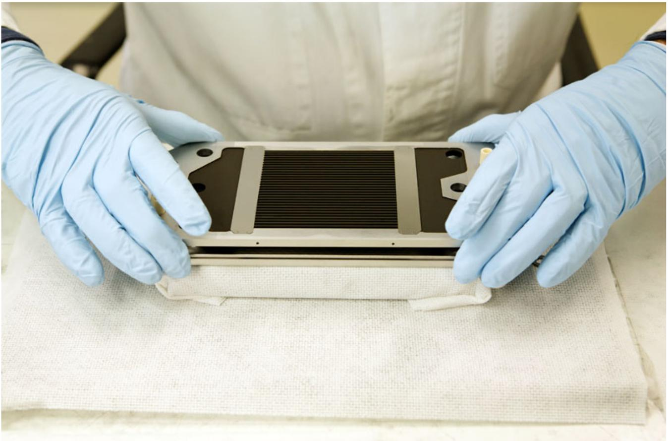
Einen verbesserten Hochleistungswerkstoff für Festoxid-Brennstoffzellen (SOFC), den Crofer 22 H, hat ThyssenKrupp VDM gemeinsam mit dem Forschungszentrum Jülich entwickelt. In einem mehrjährigen Projekt ist der Crofer 22 H zur Marktreife geführt worden.
