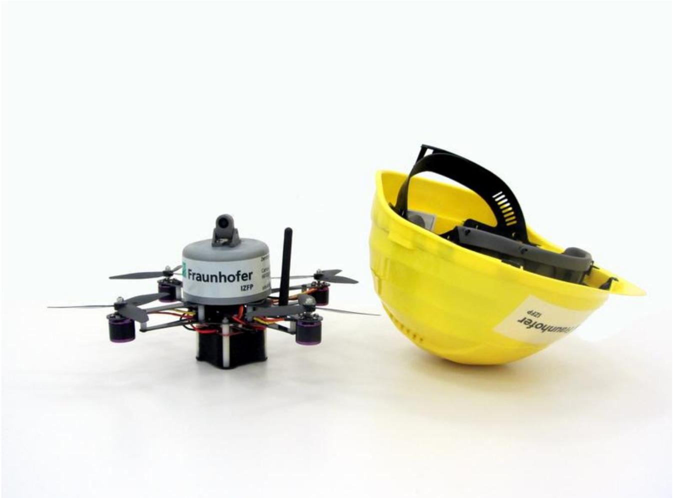
Die Oktokopter gibt es in verschiedenen Größen. So nutzen die Ingenieure des Fraunhofer Instituts für Zerstörungsfreie Prüfverfahren auch dieses kleine Modell, das einen Durchmesser von circa 36 cm besitzt und weniger als 500 g wiegt.
