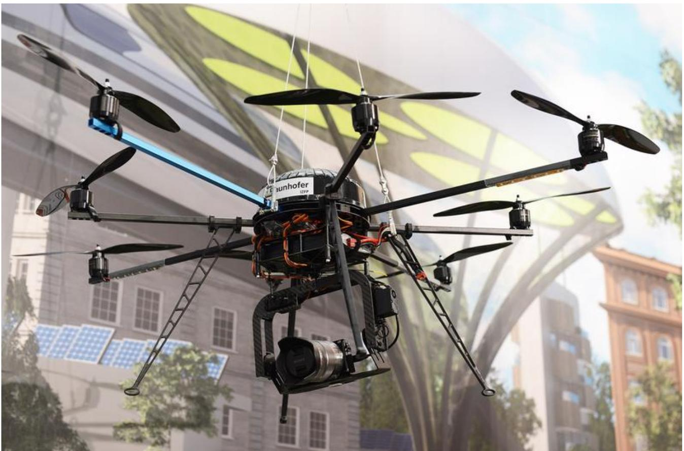
Mit diesem 1,2 Meter großen Oktokopter können Ingenieure des Fraunhofer Instituts für Zerstörungsfreie Prüfverfahren und der Saar-Uni Schäden an Brücken und Gebäuden einfach erfassen.
