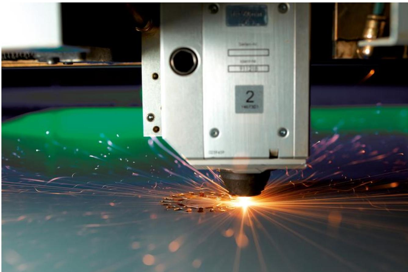
Laserschneiden von Elektroband
