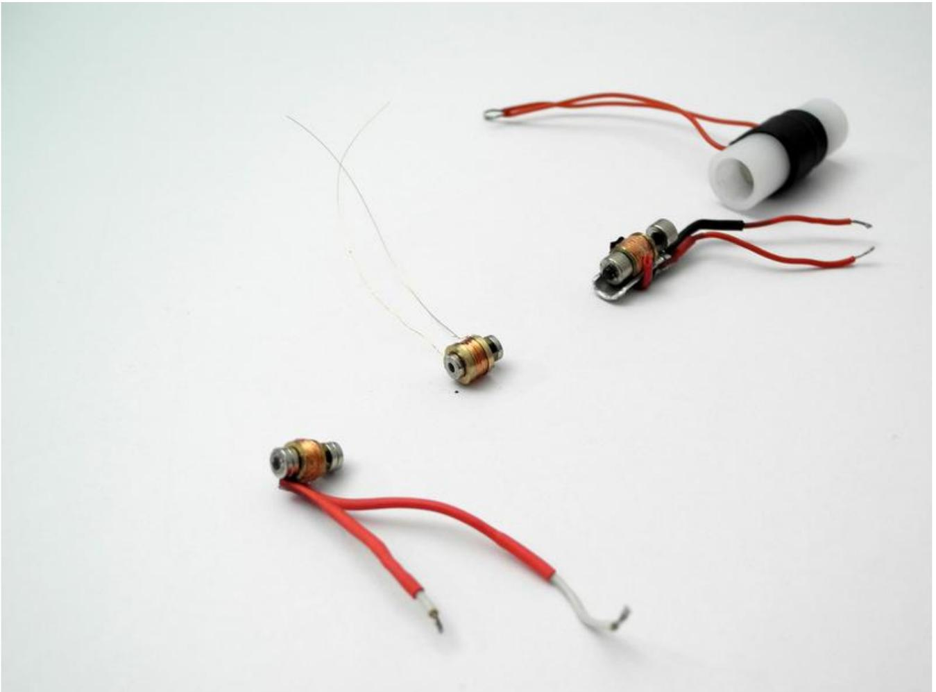
Kleines Gerät – große Wirkung: Mit dem „STT 01 – Small Tactile Transducer“ können Vibrationen und Einzelimpulse erzeugt werden. Die Erfindung wurde international zum Patent angemeldet.
