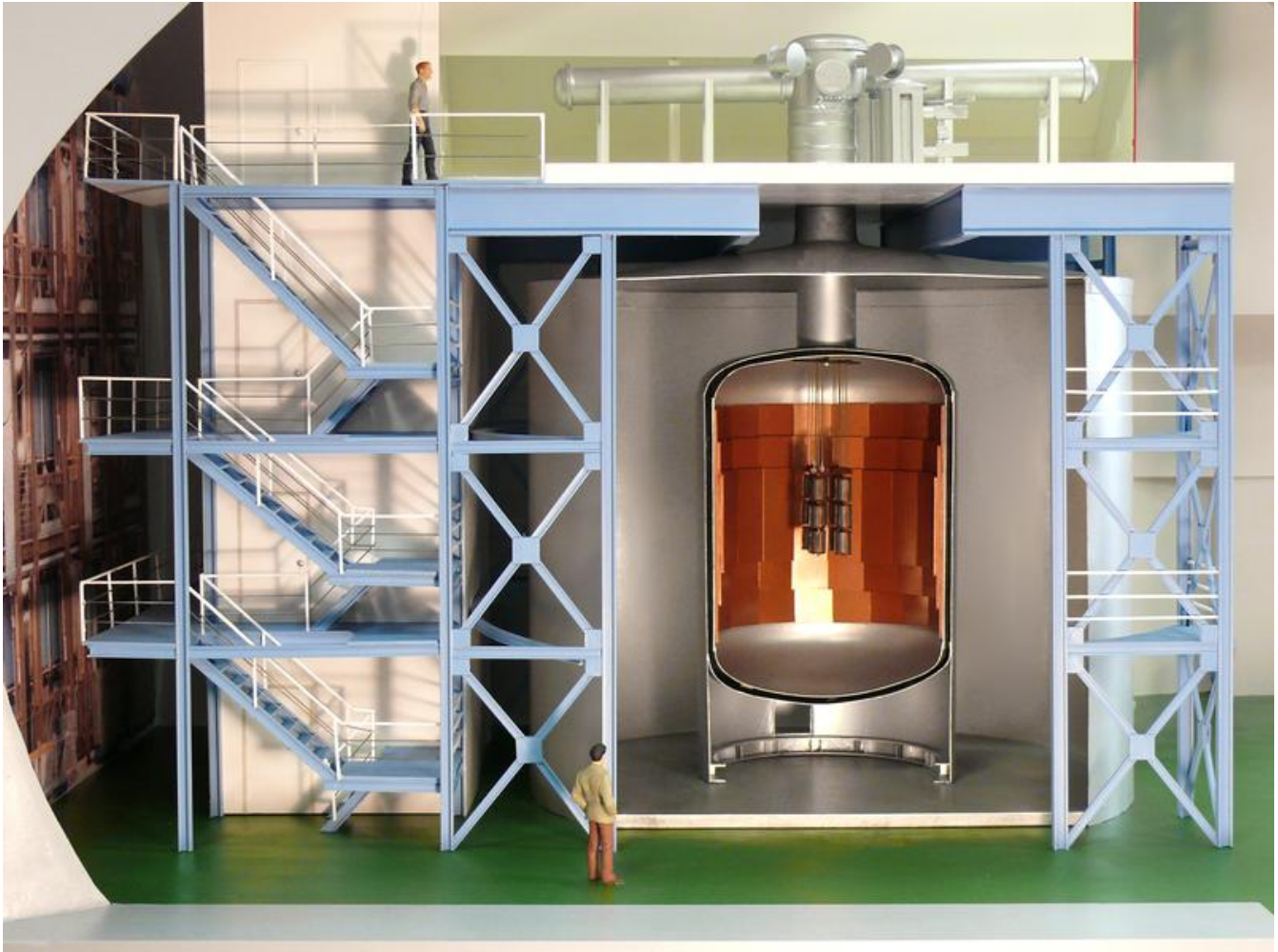
Das Modell des GERDA-Experiments zeigt den schalenartigen Aufbau, bei dem zur Unterdrückung störender Signale aus der Umgebung von außen nach innen immer reinere Materialien eingesetzt sind. Die Germaniumdioden im Innern des mit 64000 Liter flüssigem, minus 186 Grad Celsius kaltem Argon gefüllten Kryostaten sind vergrößert dargestellt. MPIK
