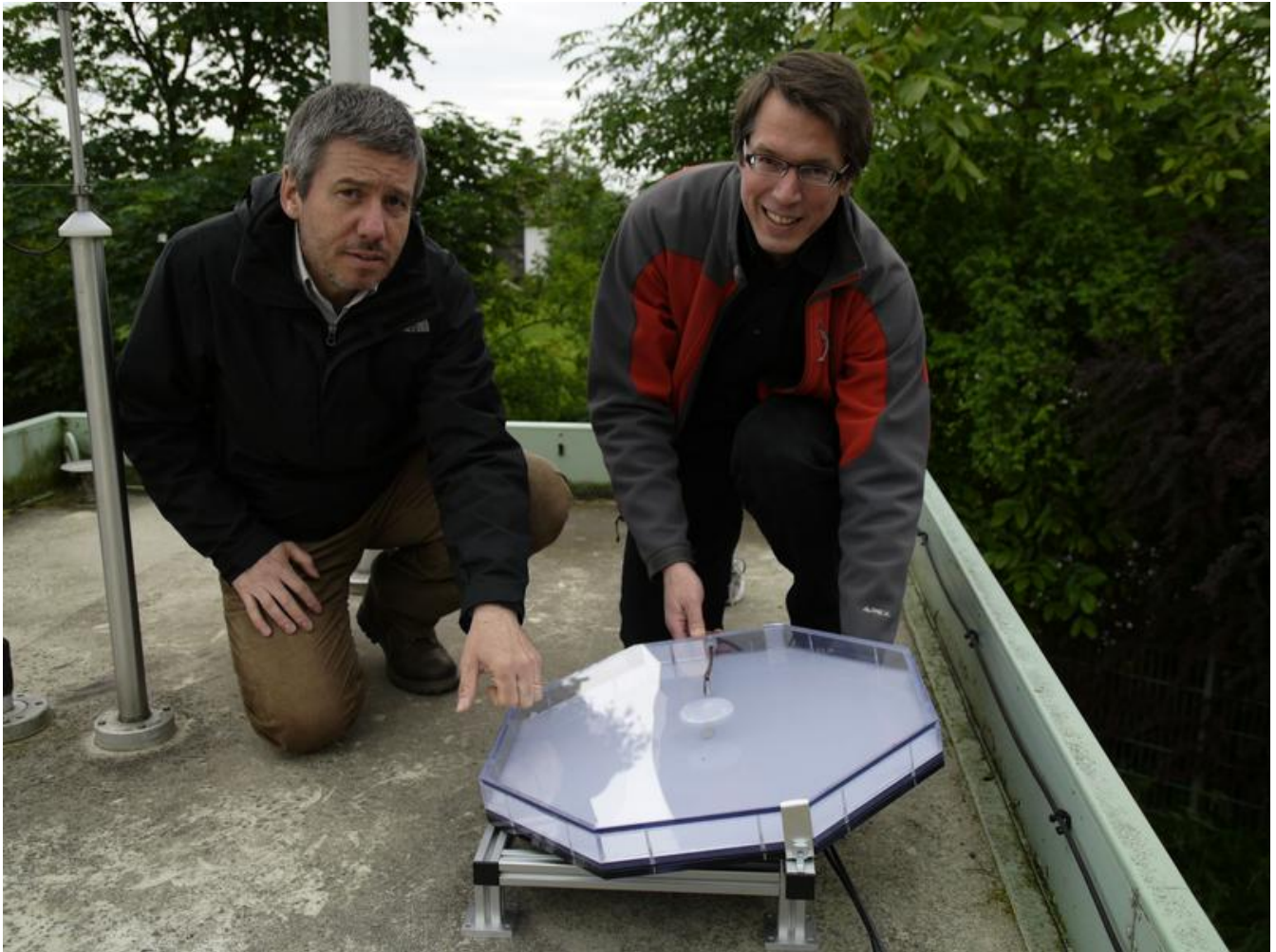
Installation eines Hagelsensors auf dem Dach der LUBW-Messstation in Wiesloch: Prof. Martin Löffler-Mang, Dr. Michael Kunz (von links) IMK-TRO
