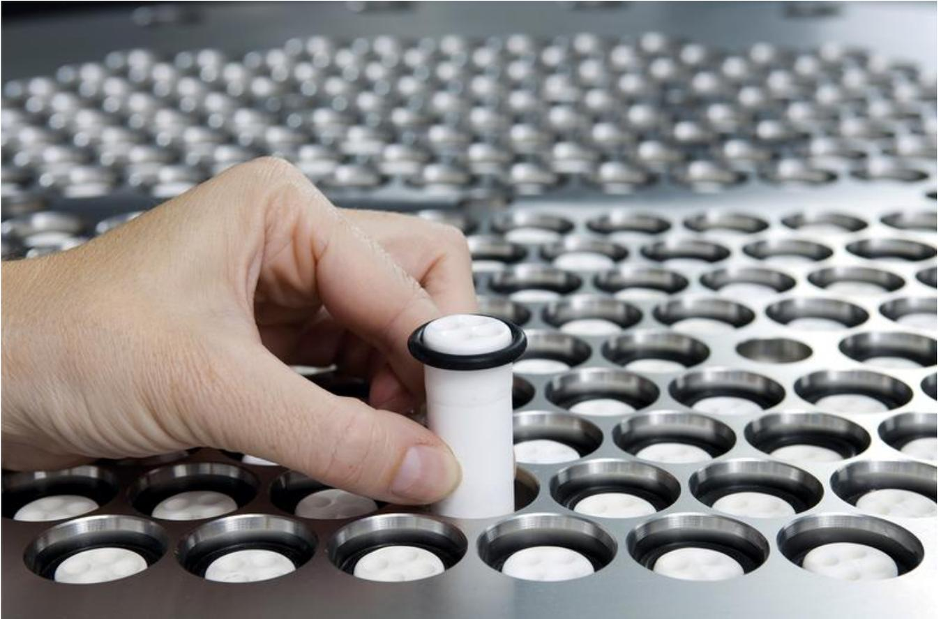
Fraunhofer-Membranen und Katalysatoren sind die Basis des umweltfreundlichen und hocheffizienten Membranreaktors der MUW Screentec GmbH
