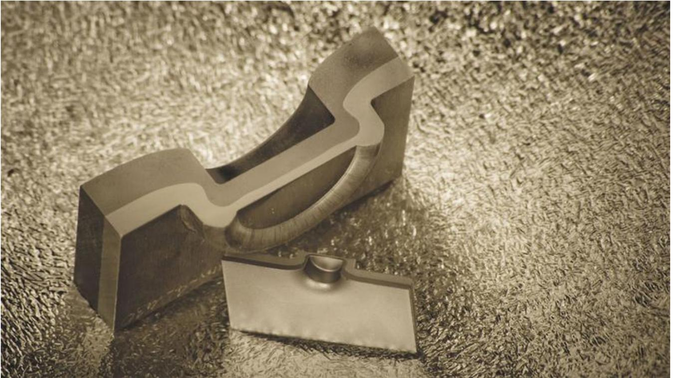
: Gesamtblechdicken von bis zu 18 mm form- und kraftschlüssig fügen: konventionelles Verfahren im Feinblechbereich (unten) vs. Dickblechclinch (oben).
