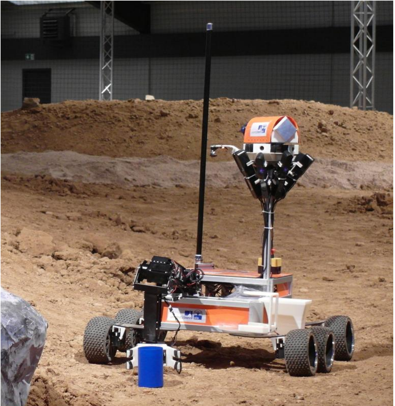
Der Roboter „Explorer“ des Teams „NimbRo Centauro“ der Universität Bonn greift und verstaut beim DLR SpaceBot Cup einen mit Wasser gefüllten Becher, ohne einen Tropfen zu verschütten.
