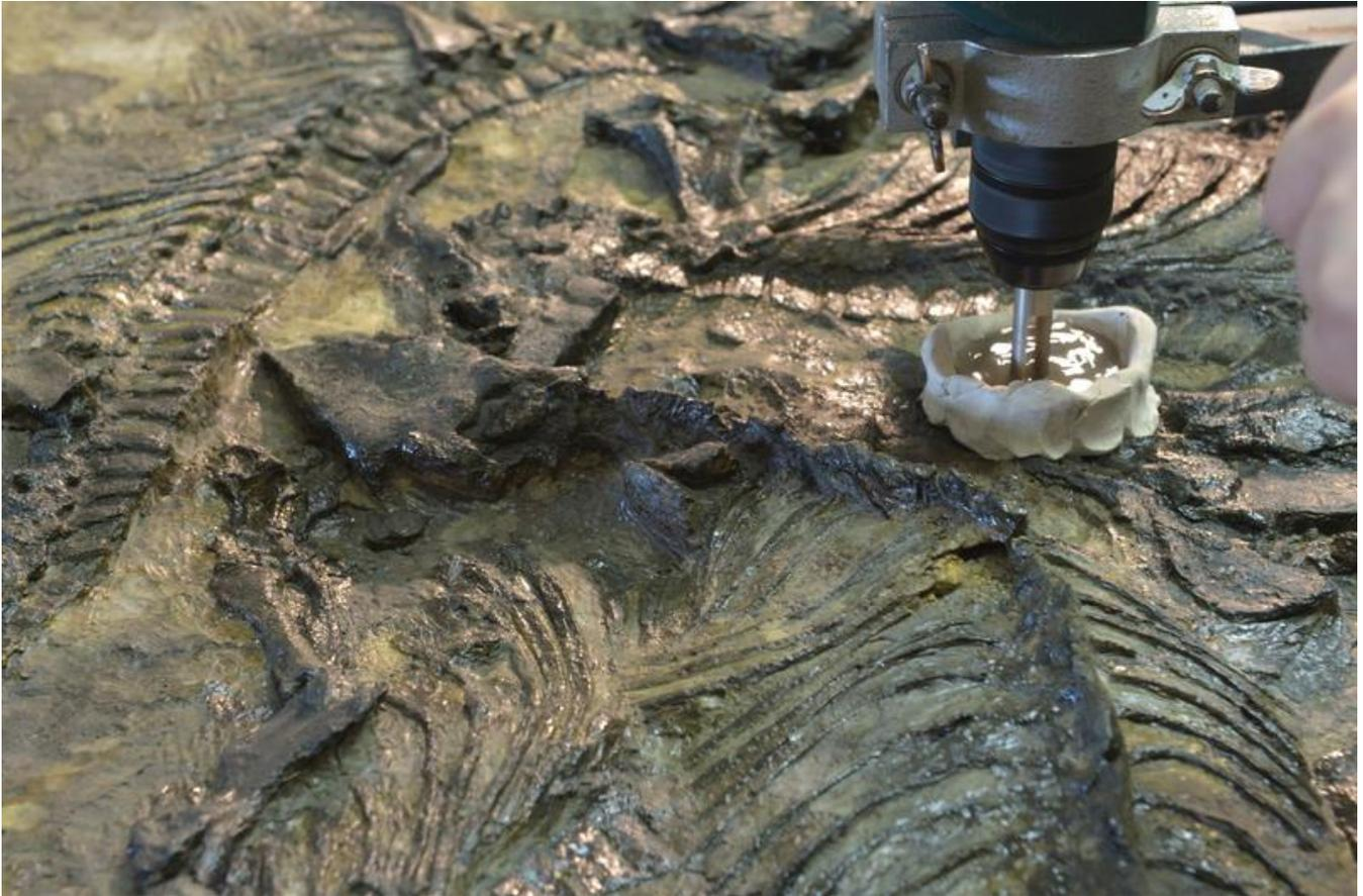
Detail: mit einem Spezialbohrer werden fossile Knochenproben gewonnen
