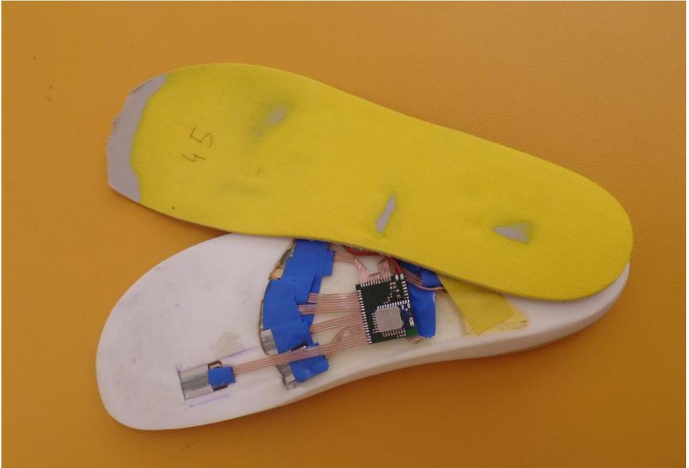
Sensor-Sohle mit integrierter Elektronik
