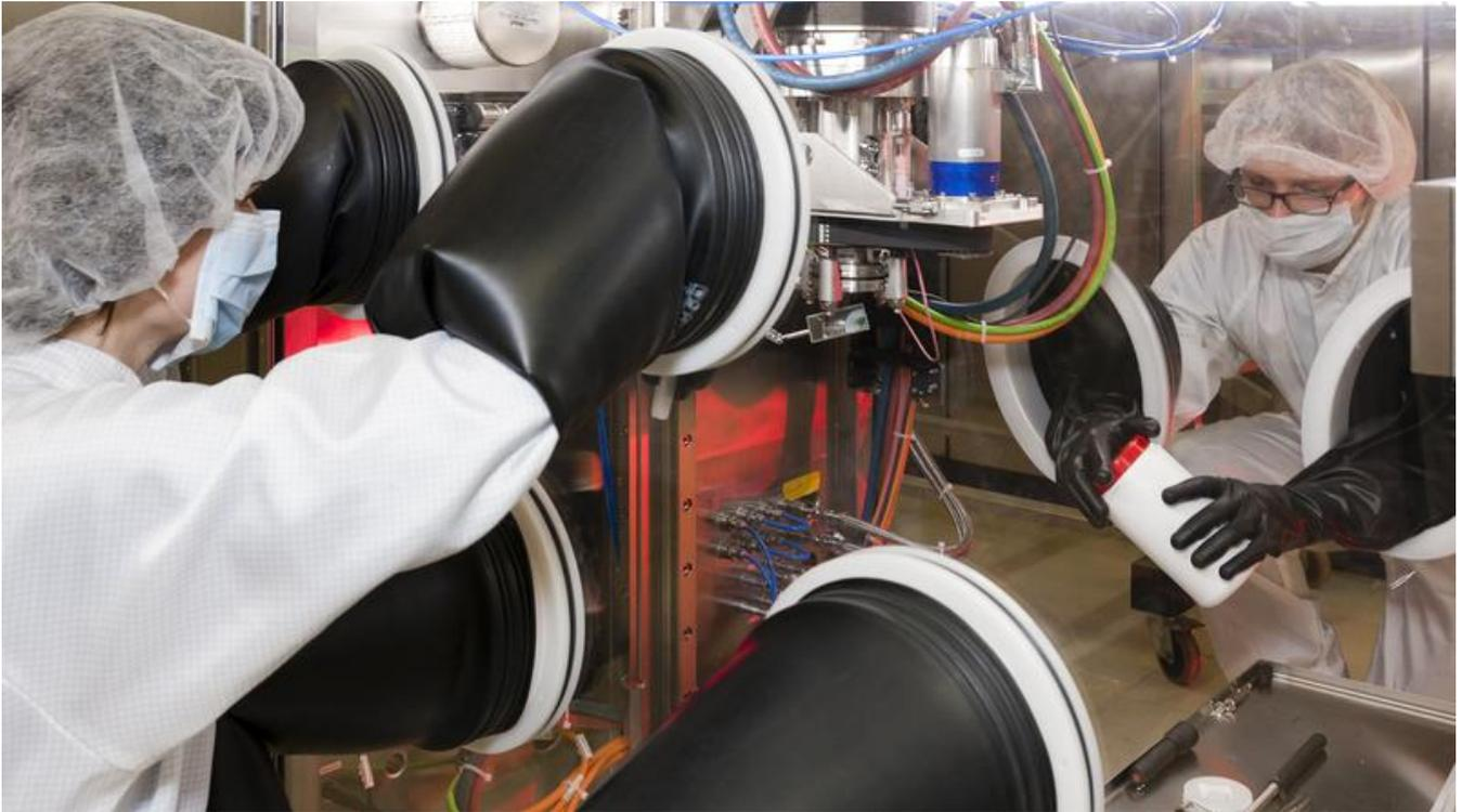
Mitarbeiter des Fraunhofer THM in Freiberg bereiten einen Kristallzüchtungsversuch in der neuen HVPE-GaN-Anlage vor.
