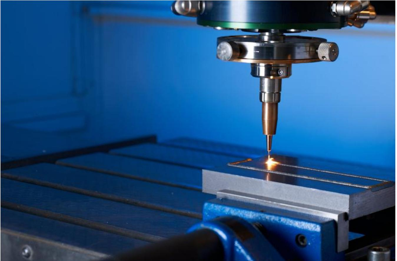
Prozess des Laser-Draht-Auftragschweißens
