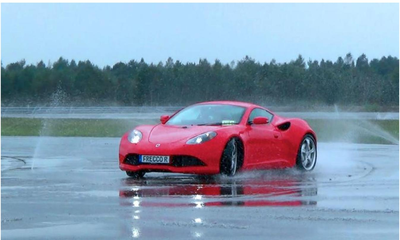
Nasshandlingkurs auf dem ATP-Prüfgelände: Weiterentwickelte Radnabenantriebe besten umfangreiche Fahrtests
