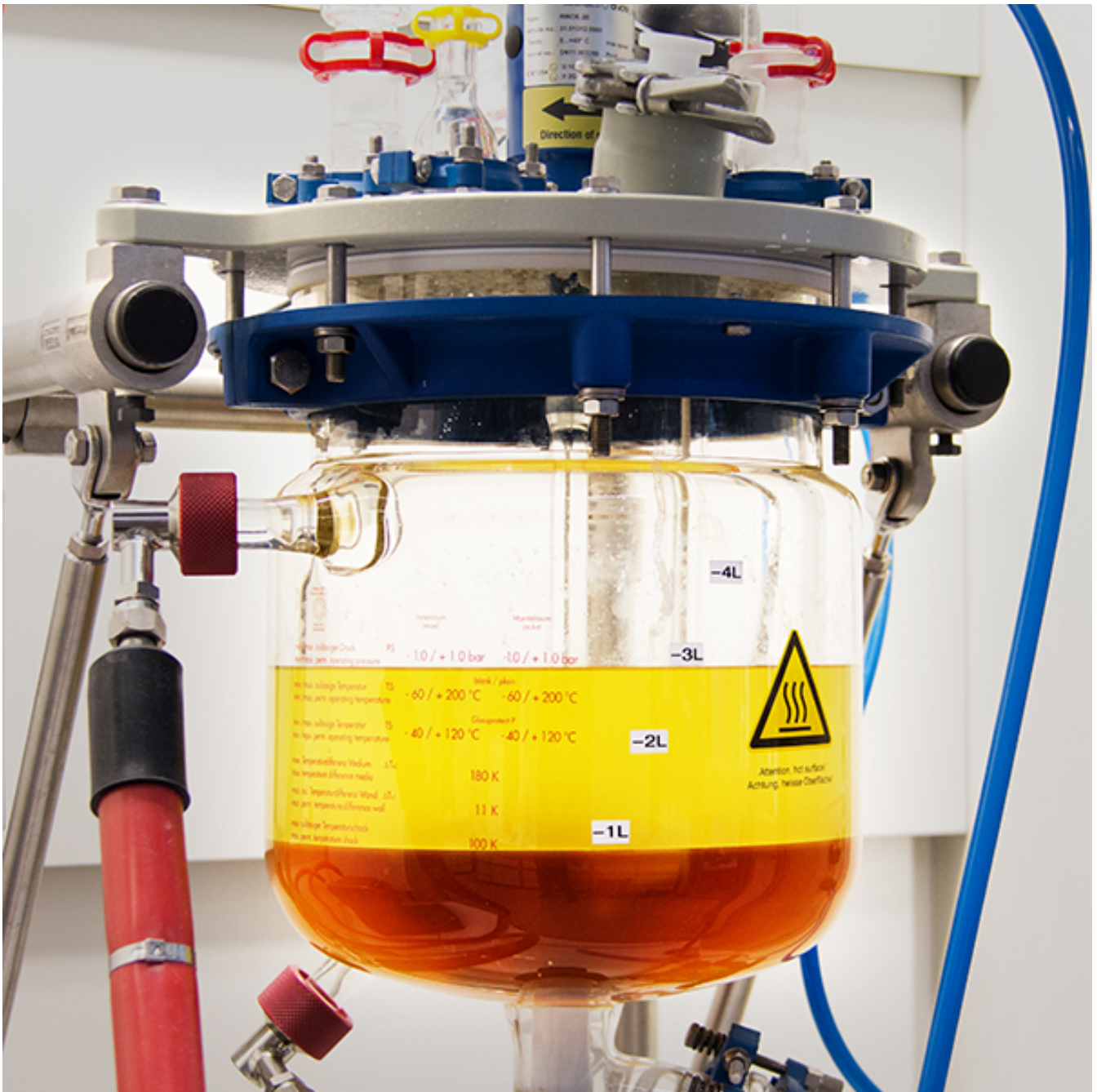
Bei der Biodiesel-Produktion entsteht Glycerin (dunkle Phase) als Nebenprodukt. Bo Cheng / ETH Zürich
