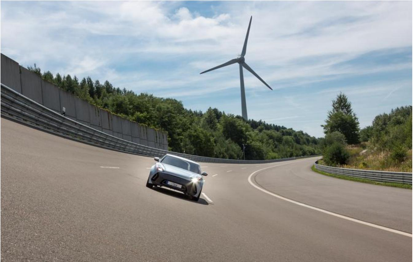
Prototyp eines Elektroautos mit Ultraleicht-Karosserie: Dank eines Mix aus Stahl und Kohlefaser wiegt das komplette fahrbereite Demonstrationsmodell weniger als 900 Kilogramm.
