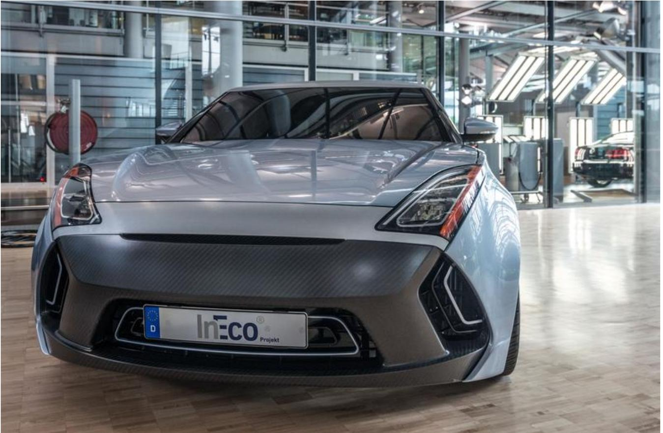
Prototyp eines Elektroautos mit Ultraleicht-Karosserie: Dank eines Mix aus Stahl und Kohlefaser wiegt das komplette fahrbereite Demonstrationsmodell weniger als 900 Kilogramm.
