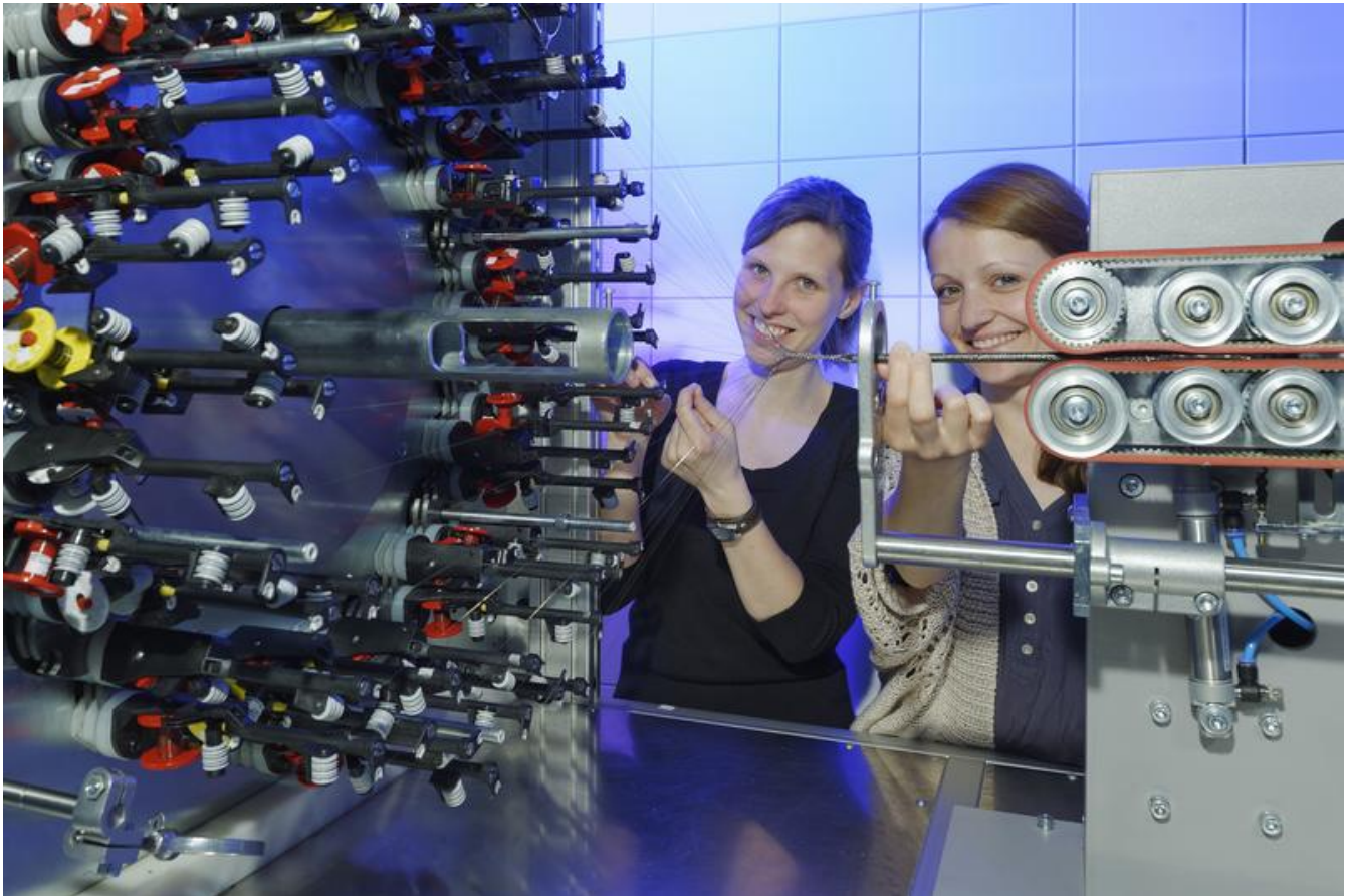
Bei der Entwicklung vitaler Stents für eine bioverträgliche Implantation werden textile Technologien eingesetzt. Peter Winandy
