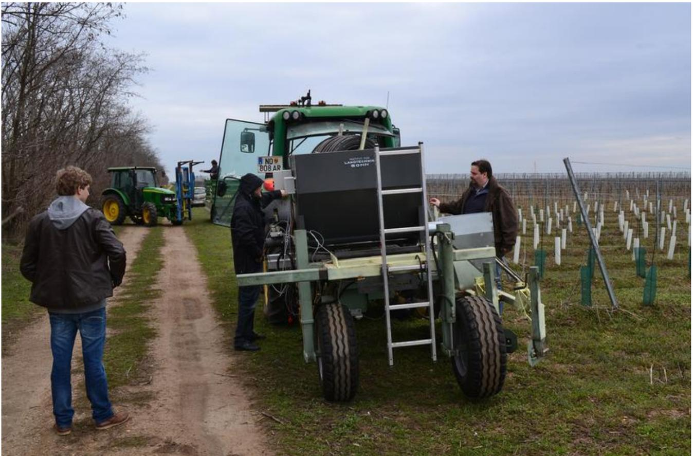
Grabenfräse zur Einbringung von Bodenhilfsstoffen: Der Prototyp wurde vom Institut für Landtechnik der Universität Bonn und der Firma Dröppelmann im Rahmen eines EU-Projektes entwickelt.
