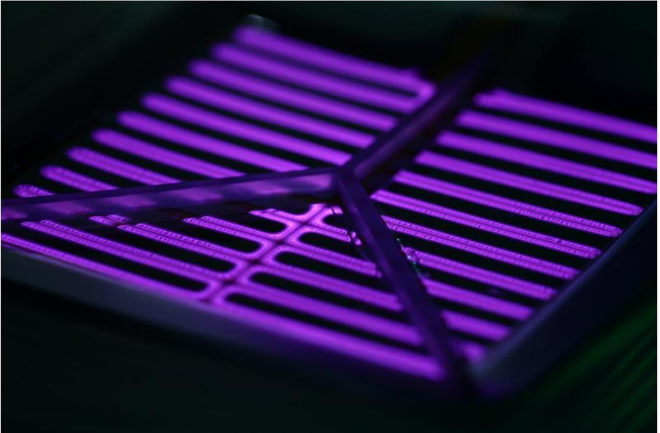
Die neuartige Wundauflage erzeugt ein hautverträgliches, blau leuchtendes Plasma, das Mikroorganismen inaktiviert und zusätzlich die Regenerierung des geschädigten Gewebes anregt.
