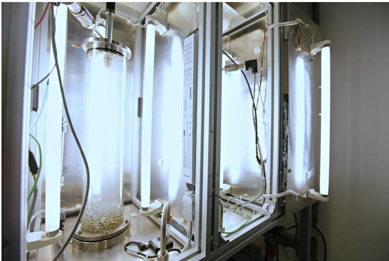
Prüfstand zur Untersuchung der Wirkfähigkeit von Mineralöl-Additiven bei der Zumischung zu Brenn- und Kraftstoffen. (Foto: OWI) OWI Oel-Waerme-Institut GmbH
