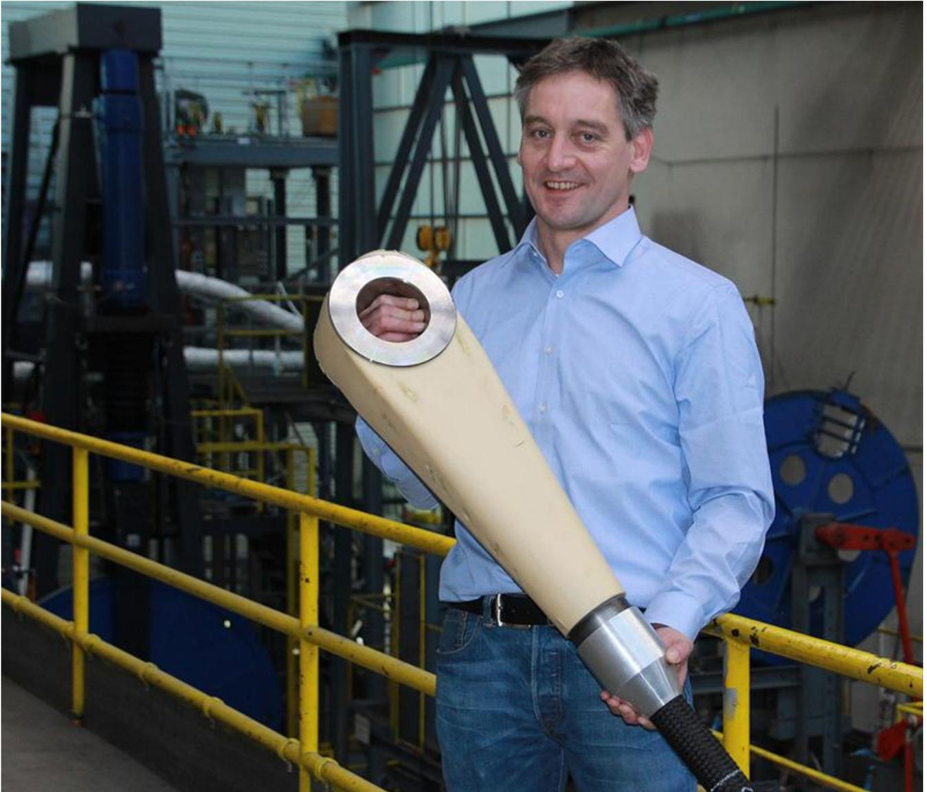
Diplom-Ingenieur Sven Winter hat eine neue Seilendverbindung für 4 bis 96 mm starke Faserseile entwickelt, die einer enorm hohen Zugkraft ausgesetzt werden kann, ohne zu brechen.
