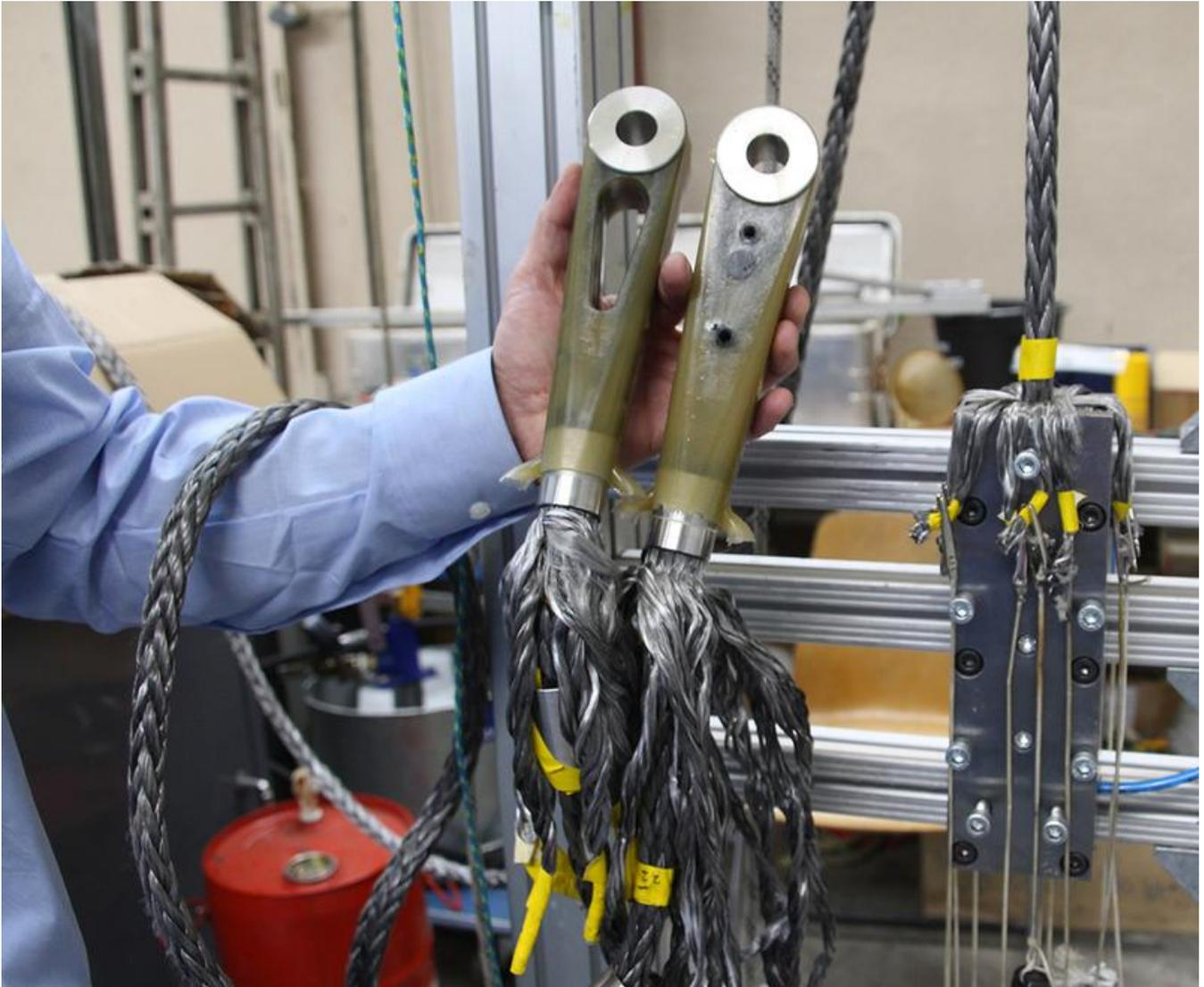
Die Endverbindung aus Faserseil und Gießharz ist enorm stabil und langlebig, wiegt aber nur ein Achtel eines Stahlseils.
