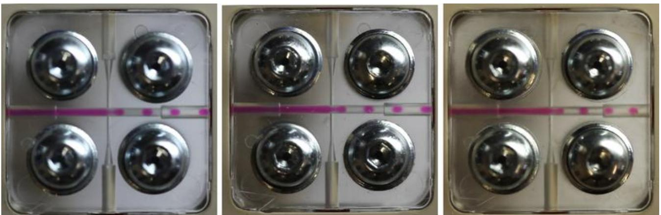
Abb. 2: DMEM Segmentierung in Perfluorodecalin mit hydrophobisierten, mikrostrukturierten Spritzguss gefertigten FMS; links: FMS aus PC2805; rechts: FMS aus COC6017.
