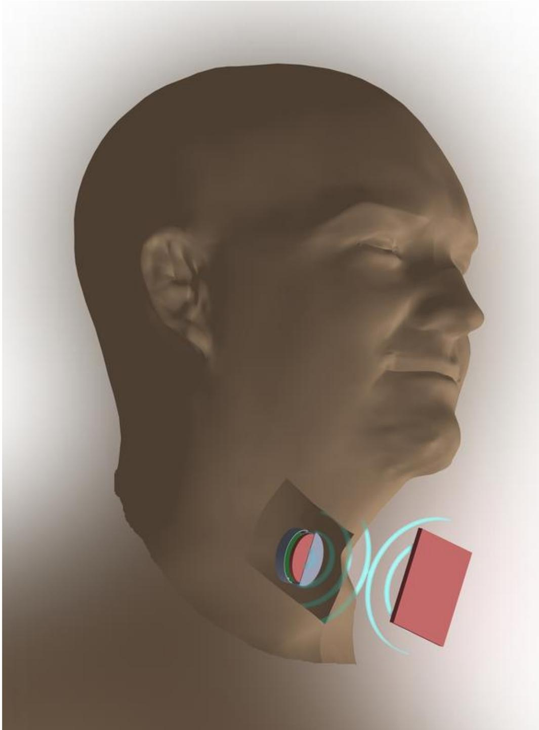
Prinzipieller Aufbau der ultraschallbasierten Energieversorgung und Kommunikation.
