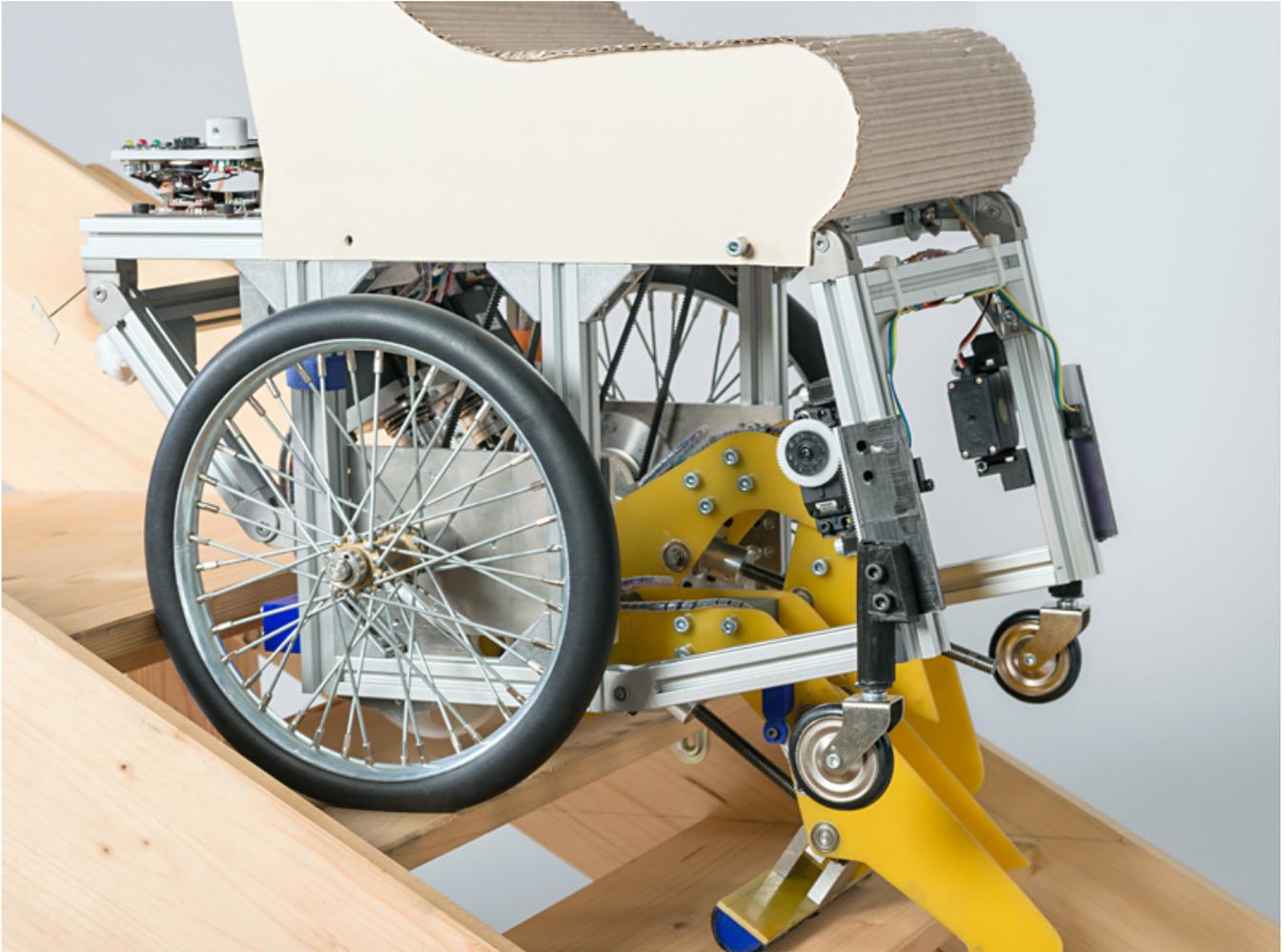
Der bionische Rollstuhl kann selbstständig Treppen steigen.
