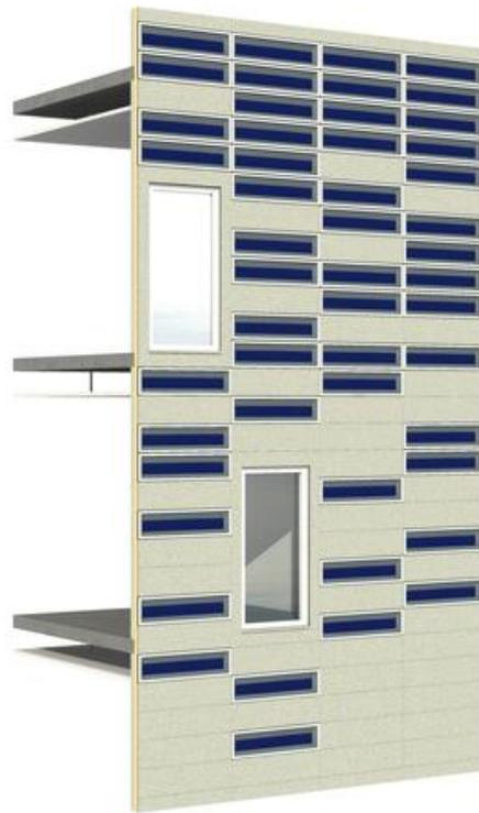
Visualisierung einer Fassade mit Streifenkollektoren
