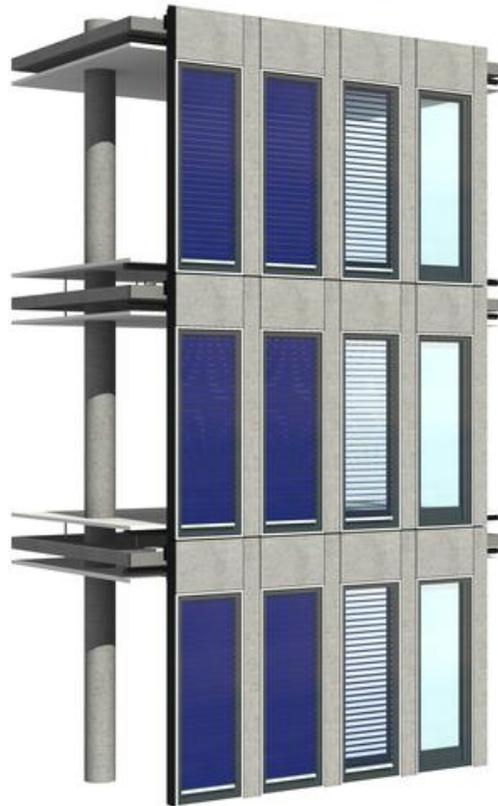
Visualisierung einer Fassade mit solarthermischer Jalousie
