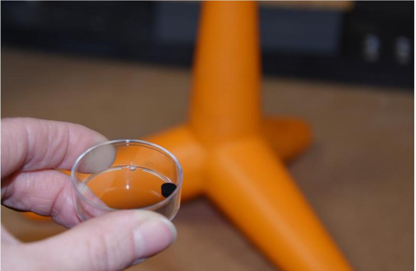
Bildunterschrift: Das schwarze Aerographit gilt als leichtestes Material der Welt. Aufgebaut ist es aus winzigen Tetrapodenstrukturen wie das orange Modell. Foto/Credit: Siekmann/CAU
