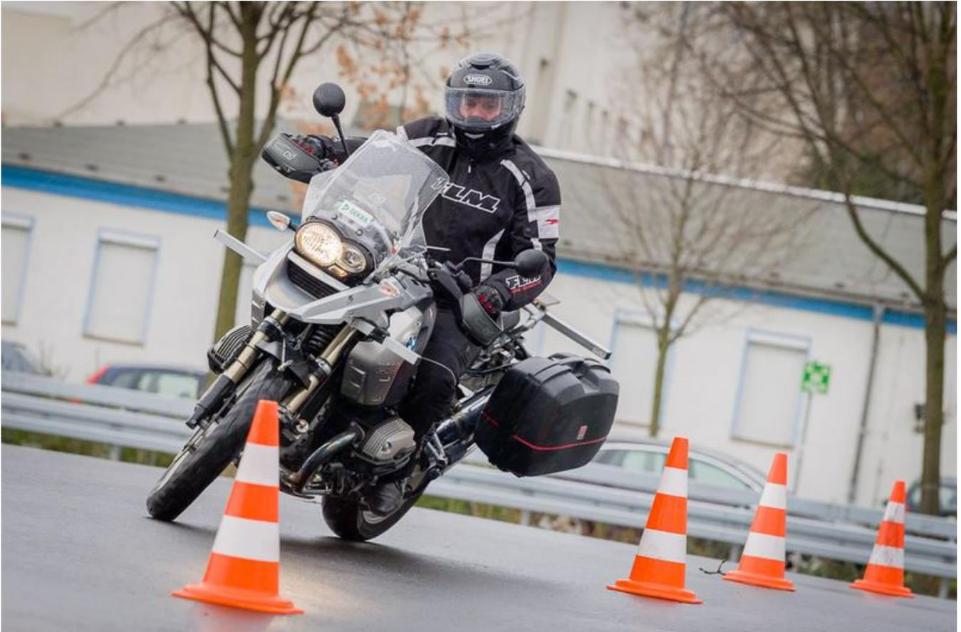
Im Rahmen der Eröffnung wurde auch ein neues Messmotorrad übergeben. Auf dem Prüffeld werden damit Untersuchungen zum Fahrverhalten beim Motorradfahren durchgeführt.
