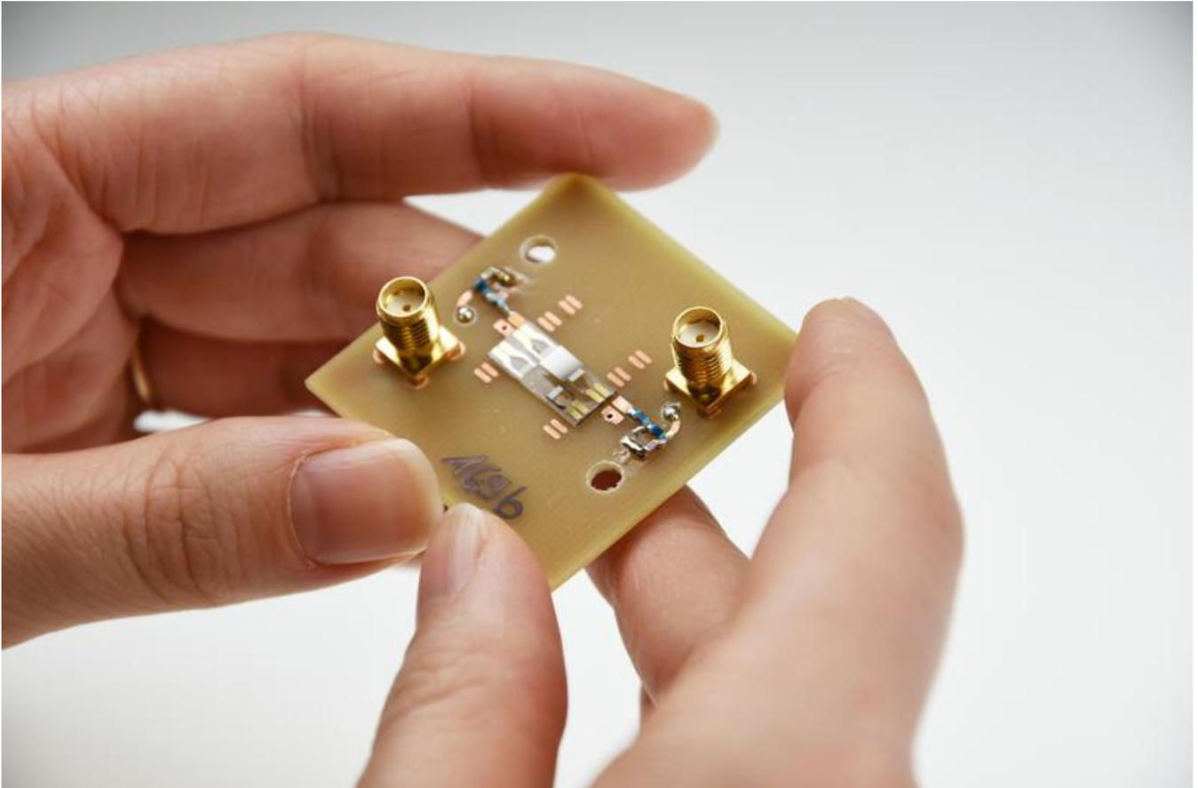
Die Oberflächenwellensensoren, die Forschende im Kieler SFB 1261 entwickelt haben, sollen langfristig biomagnetische Felder detektieren können.
