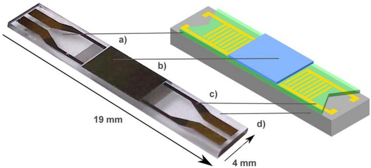
Der schematische Aufbau des Sensors aus einem magnetostruktiven Dünnschicht (b) auf einem piezoelektrischen Substrat (d).
