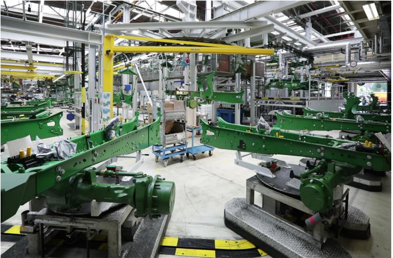
Auf der Fertigungsline bei John Deere in Mannheim werden über 60 Montagevarianten durchgeführt. Fraunhofer IPA, Rainer Bez
