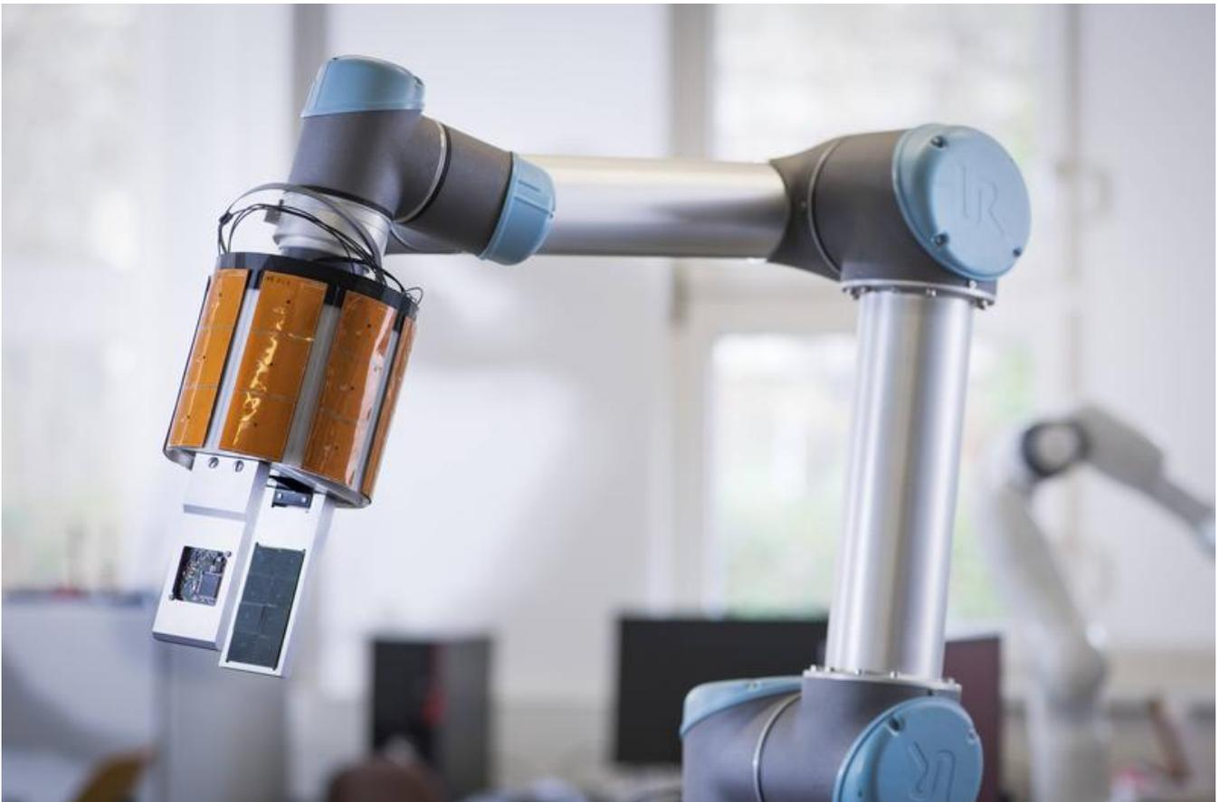
Robotergreifarm mit taktilen Näherungssensoren: Die multimodale Sensorik verbesserte die Kooperation zwischen Mensch und Roboter – und macht sie sicherer.
