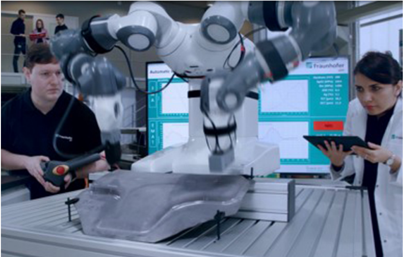
Die Wissenschaftlerin Dr. Yasmine Gabi und der Ingenieur Frank Leinenbach bei der Prüfung eines pressgehärteten Bauteils auf relevante Qualitätsmerkmale mit robotergestützten Sensorsystemen. Fraunhofer IZFP / Uwe Bellhäuser
