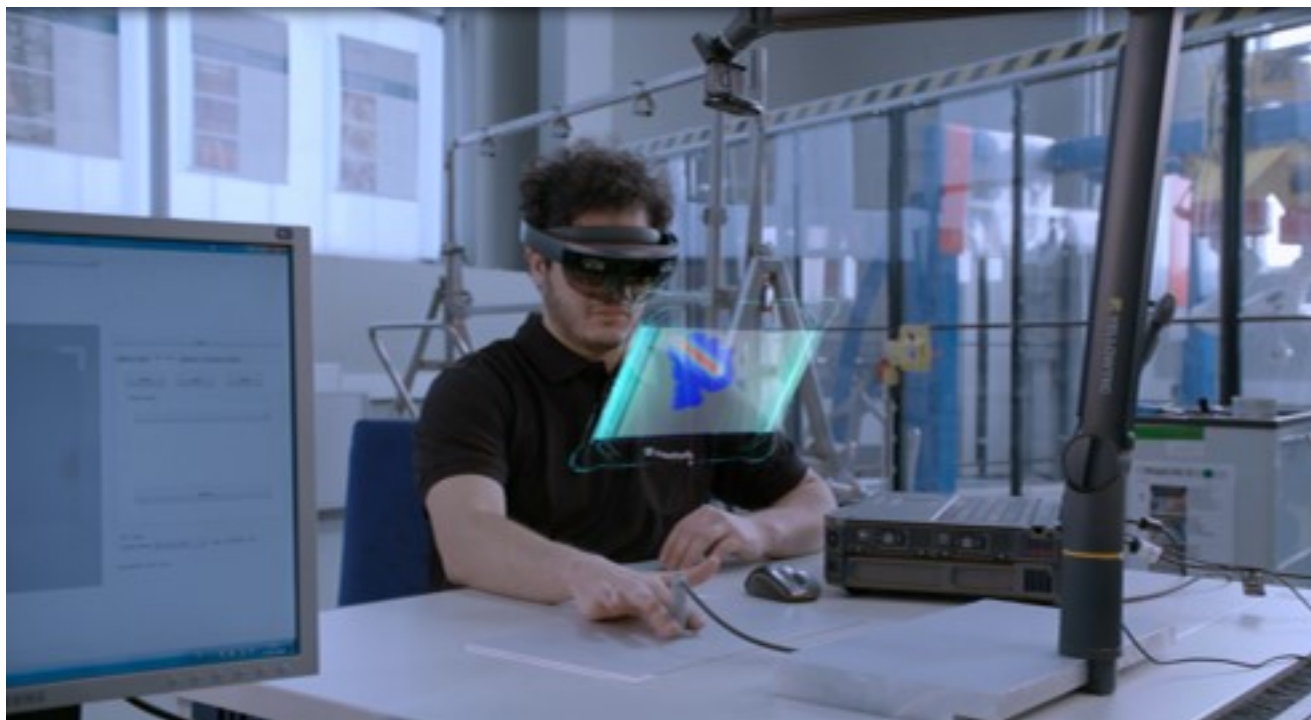
Der Wissenschaftler Ali Movahed bei der Prüfung eines Bauteils auf Fehler im Materialinneren mit einer Augmented Reality-Brille (AR). Fraunhofer IZFP / Uwe Bellhäuser
