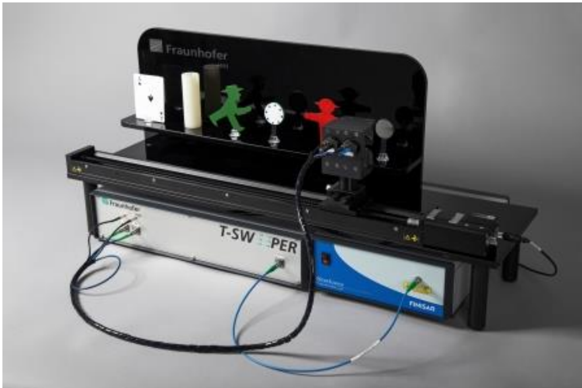
Das Foto zeigt den T-Sweeper und die schnell durchstimbare Laserquelle Finisar® WaveSource™ im Demonstrationsaufbau zur Schichtdickenbestimmung an unterschiedlichen Probekörpern. © Fraunhofer HHI
