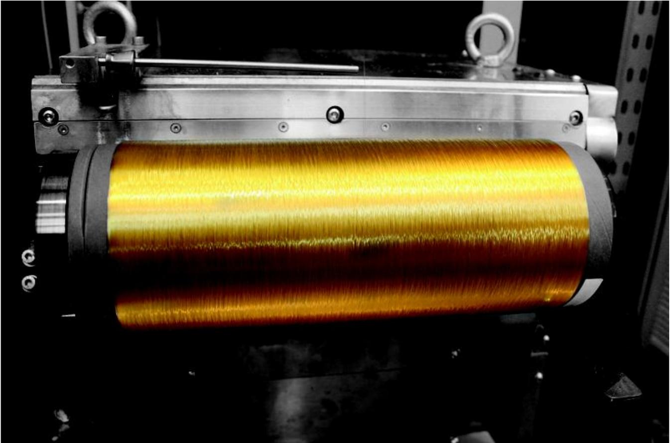
PAN-Fasern sind das perfekte Precursor-Material für die Herstellung von Carbonfasern.
