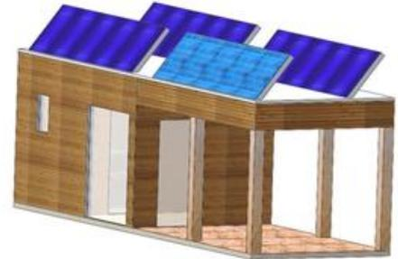
(v.l.n.r.) Schematische Darstellung der Konzepte für eine windbetriebene finnische Sauna, ein solarbetriebenes Hamam und eine hybride Anlage für süddeutsche Klimabedingungen.
