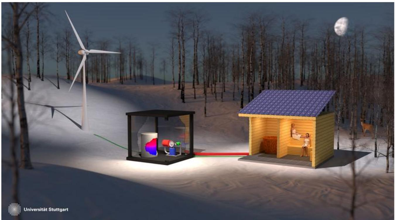
Energiesystem „Null-Energie-Sauna“, bestehend aus Erneuerbaren Energiequellen, Sauna sowie Energiespeicher und -wandler.
