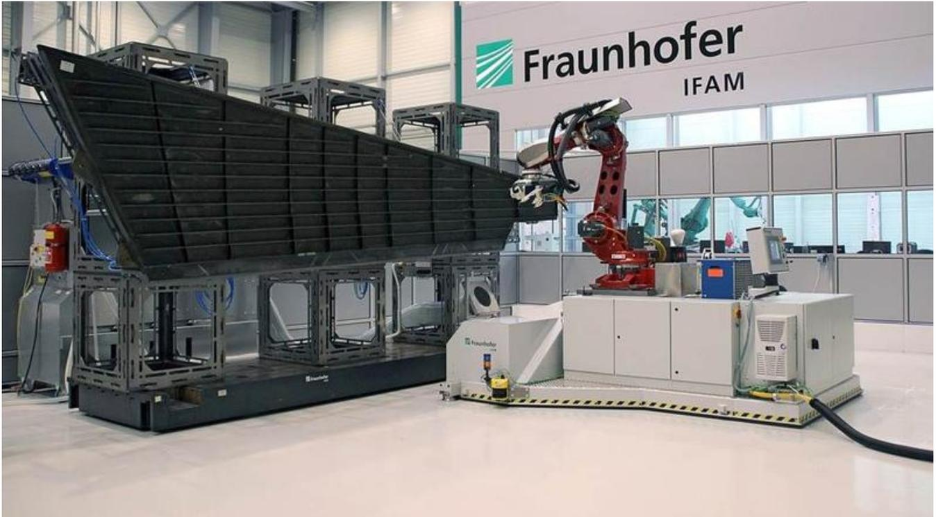
Mobiler hochgenauer Bearbeitungsroboter zur flexiblen Bearbeitung von Großstrukturen, hier das Seitenleitwerk eines Airbus 320.
