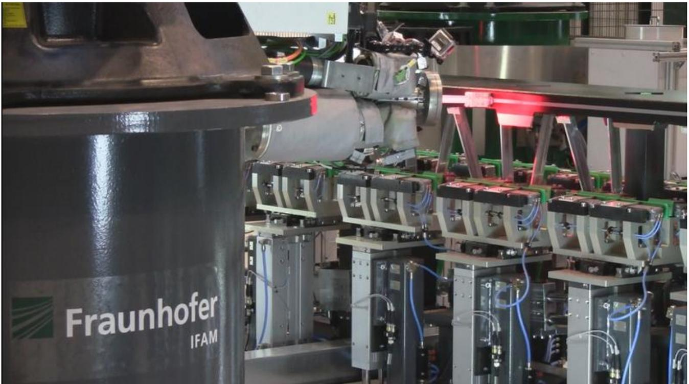
Sealing – Mengengepasster automatisierter 2K-Klebstoffauftrag im Niederdruckbereich.
