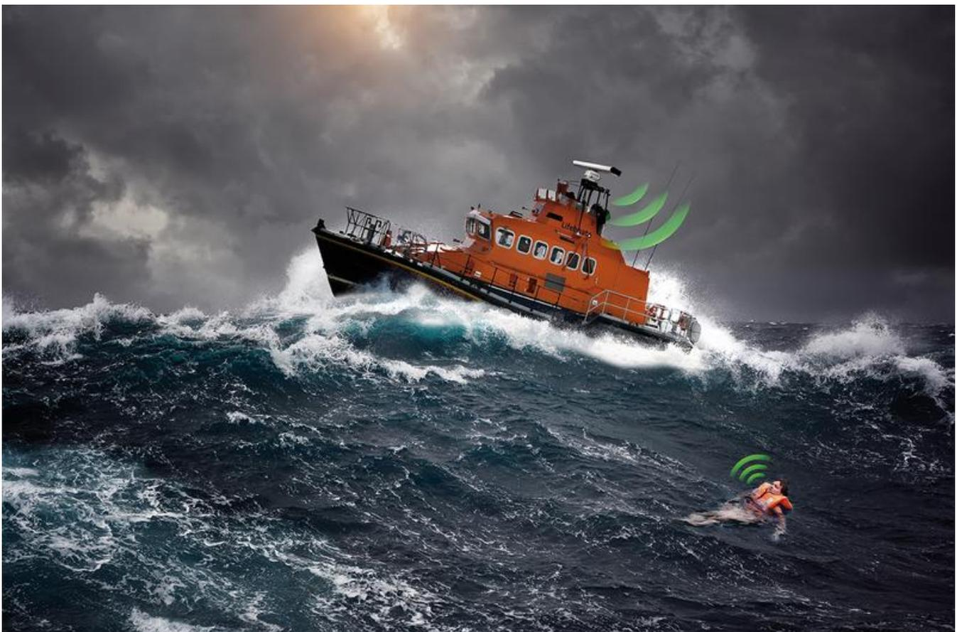
Next Generation Schiffsradare: Das harmonische Radar SEERAD soll in Zukunft Tags in Rettungswesten detektieren und Schiffbrüchige zuverlässig orten
