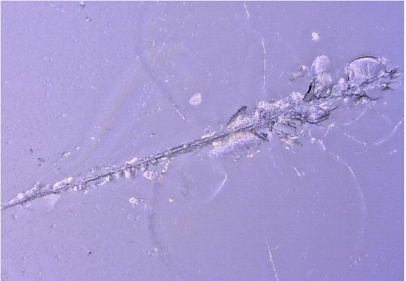
Oberfläche eines Spezialglases, wie es für Displaygläser verwendet wird. Der Kratzer mit einer Länge von 200 \mu\text{m} wurde unter kontrollierten Bedingungen mit Hilfe einer Diamantspitze erzeugt. Foto: Lothar Wondraczek/FSU
