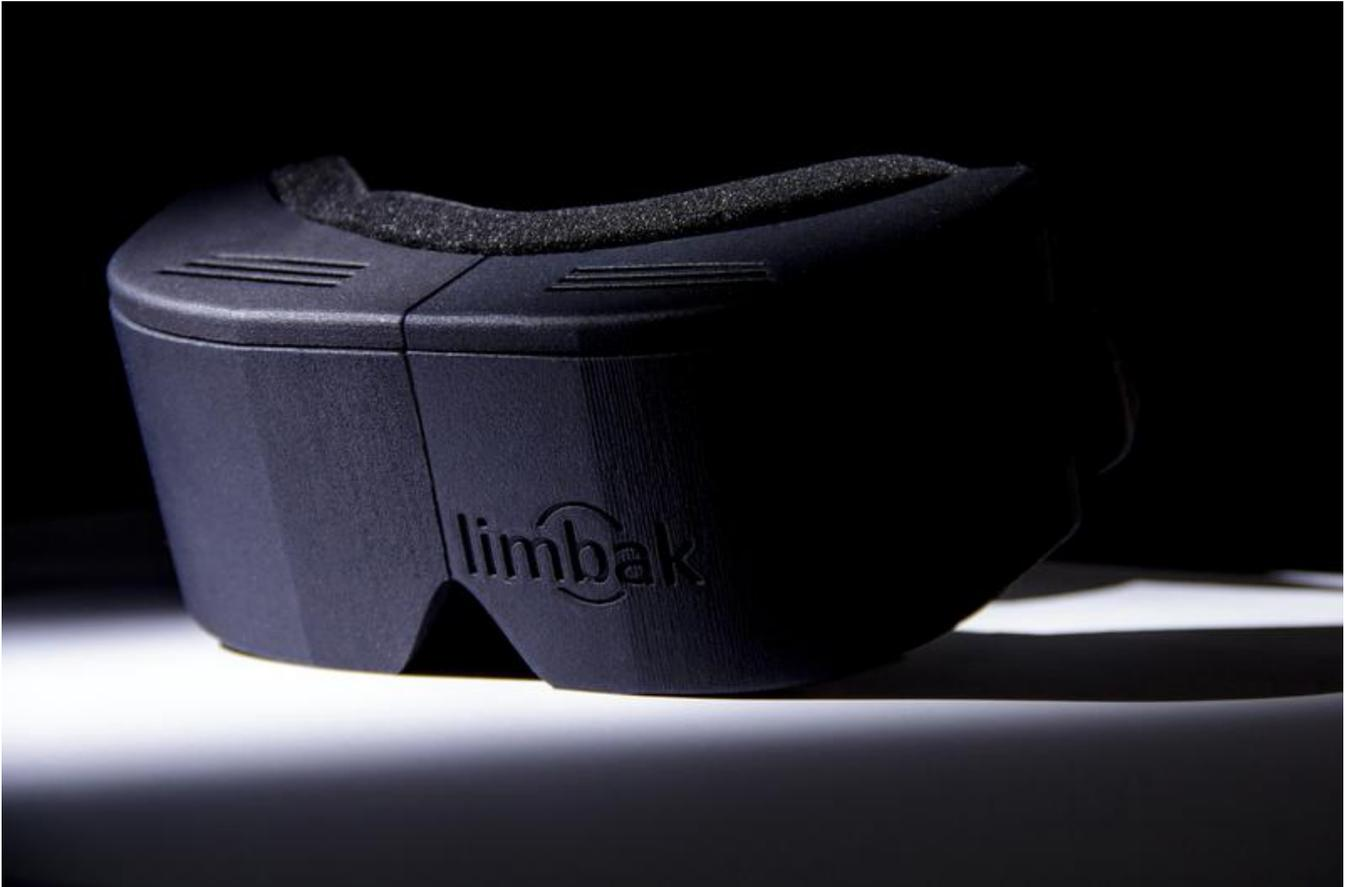
Prototyp einer VR-Brille mit 4 hochauflösenden OLED-Mikrodisplays
