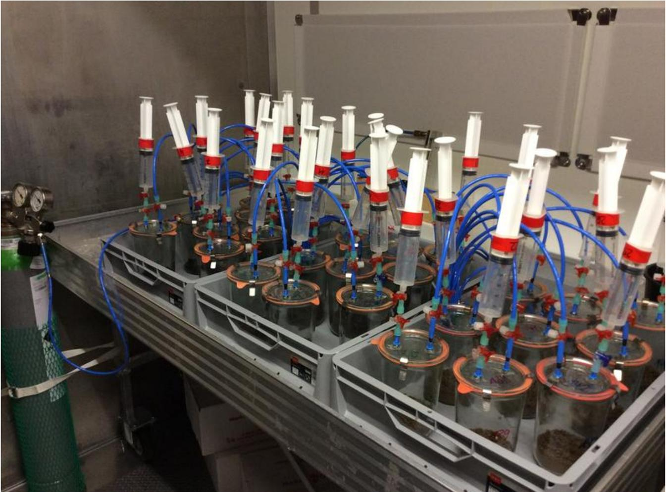
Inkubationssystem zur Messung von Lachgas (N<sub>2</sub>O) und molekularem Stickstoff (N<sub>2</sub>) in einer Stickstoff-abgereicherten Atmosphäre.
