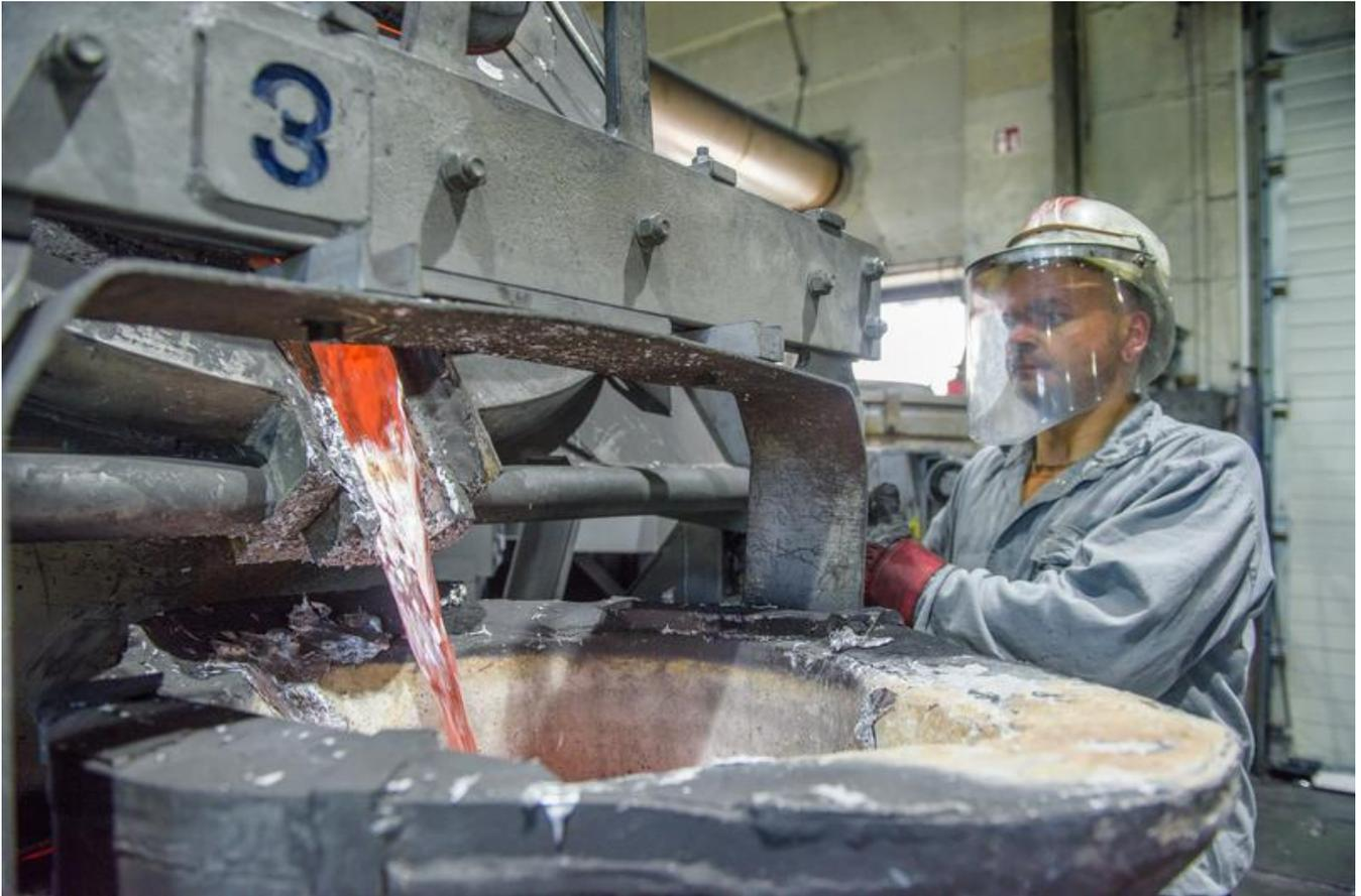
Umfüllen des geschmolzenen Metalls. Zum Schmelzen und Beheizen wird sehr viel Energie benötigt.
