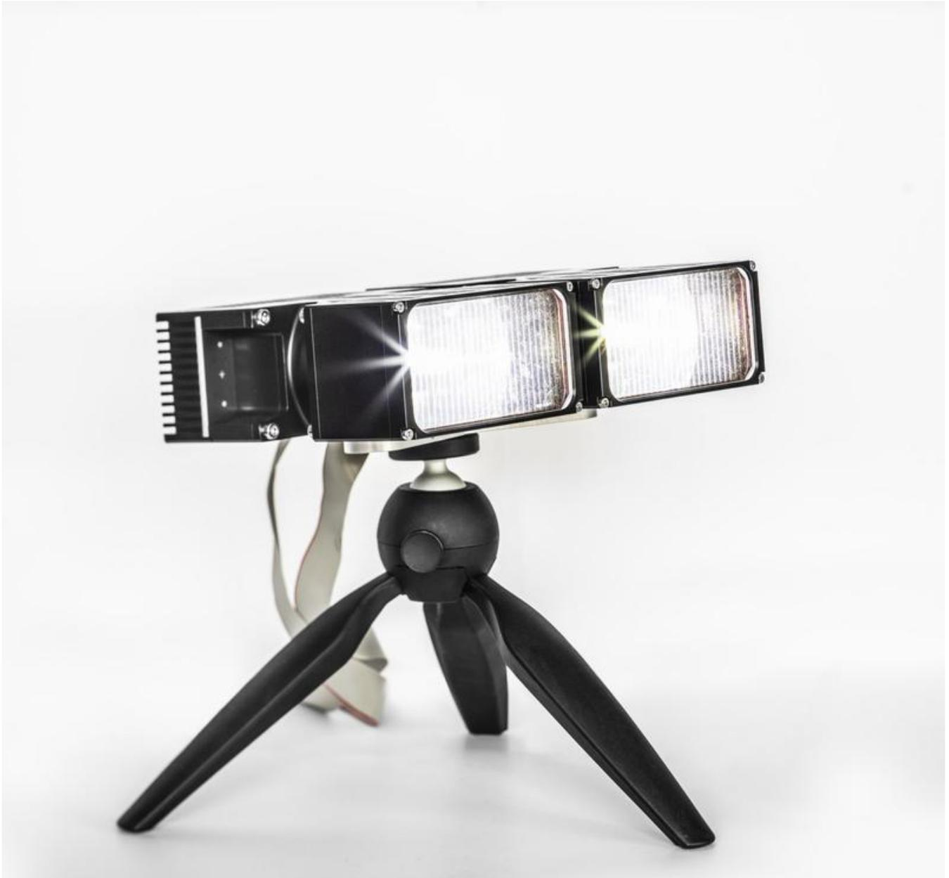
Segmentiertes, automotives LED-Fernlicht realisiert als mikrooptischer, irregulärer Wabenkondensator.
