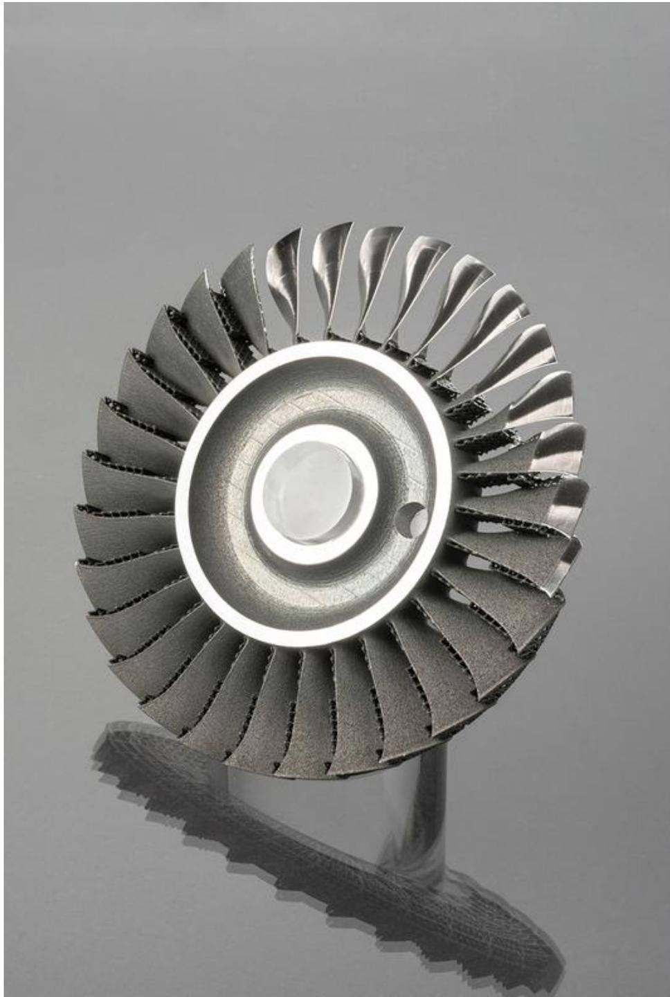
Beim »Laser Powder Bed Fusion« wird Metallpulver durch einen Laserstrahl gemäß den Geometrieinformationen Schicht für Schicht aufgeschmolzen.
