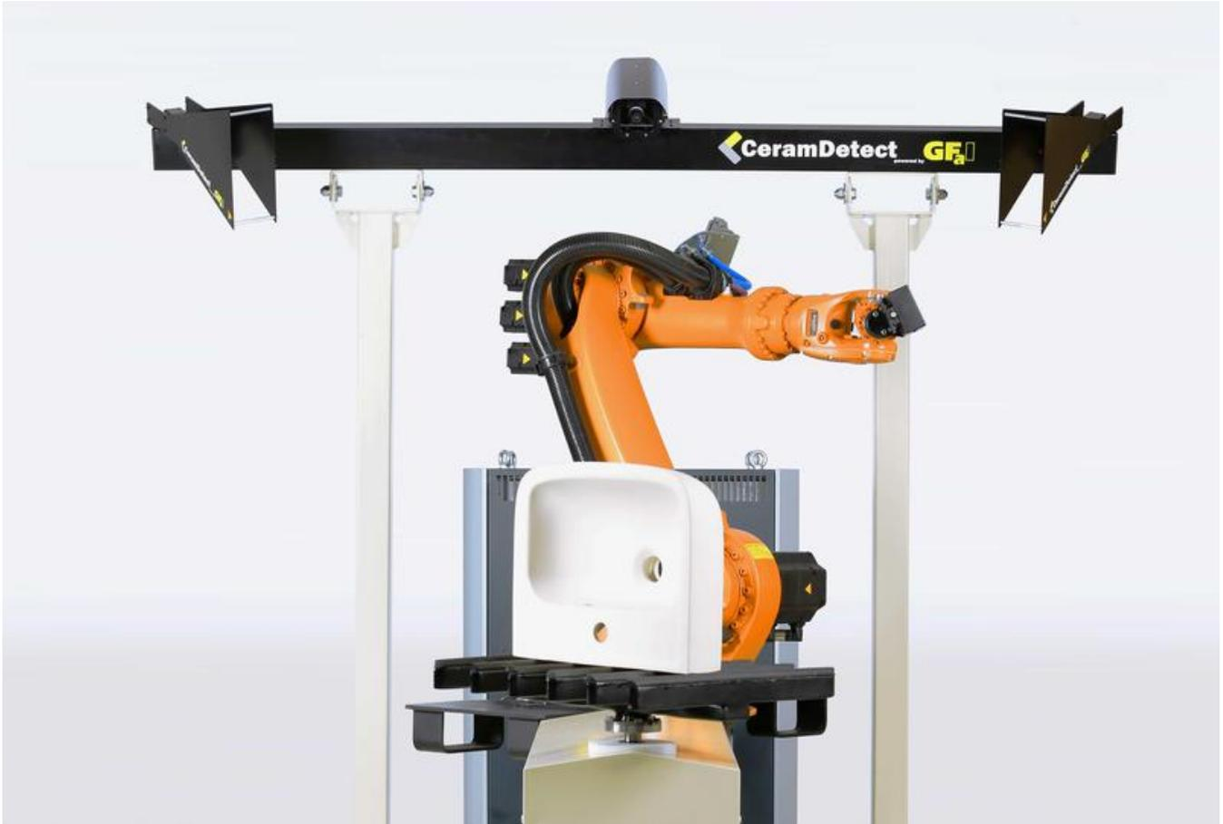
Das 3D-Erfassungssystem CeramDetect ermöglicht eine sichere Erkennung des Modelltyps und eine Lagebestimmung von Werkstücken.
