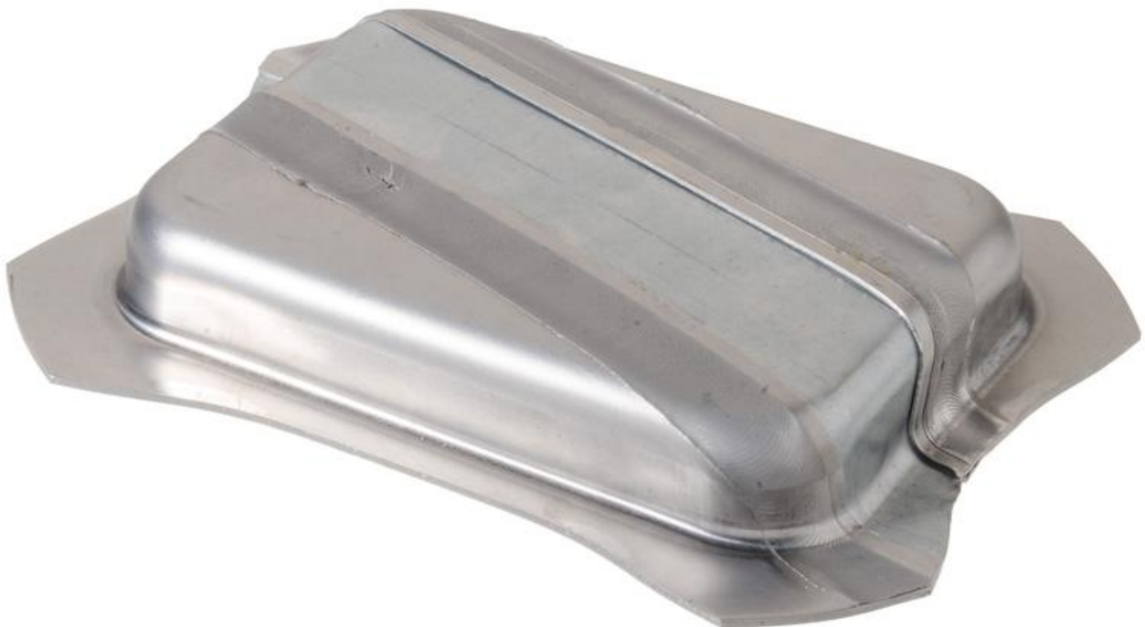
Exemplarische Technologiedemonstratoren von umgeformten hybriden Aluminium-Stahl Tailor Welded Blanks.
