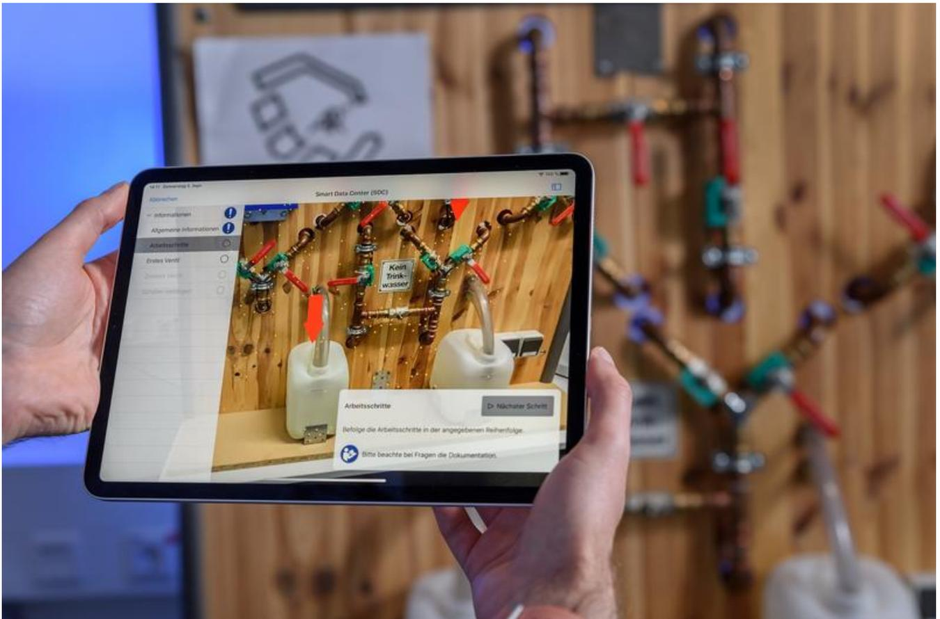
Die Anleitung kann per Tablet oder PC erstellt und später am Tablet genutzt werden. Oben links ist im Hintergrund der Marker zu sehen, der dem Tablet die Orientierung ermöglicht.
