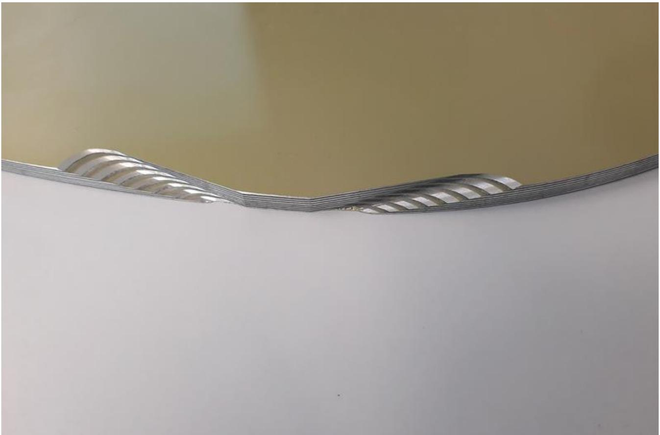
Verbund aus glasfaserverstärktem Kunststoff und Aluminium, sogenanntes GLARE.
