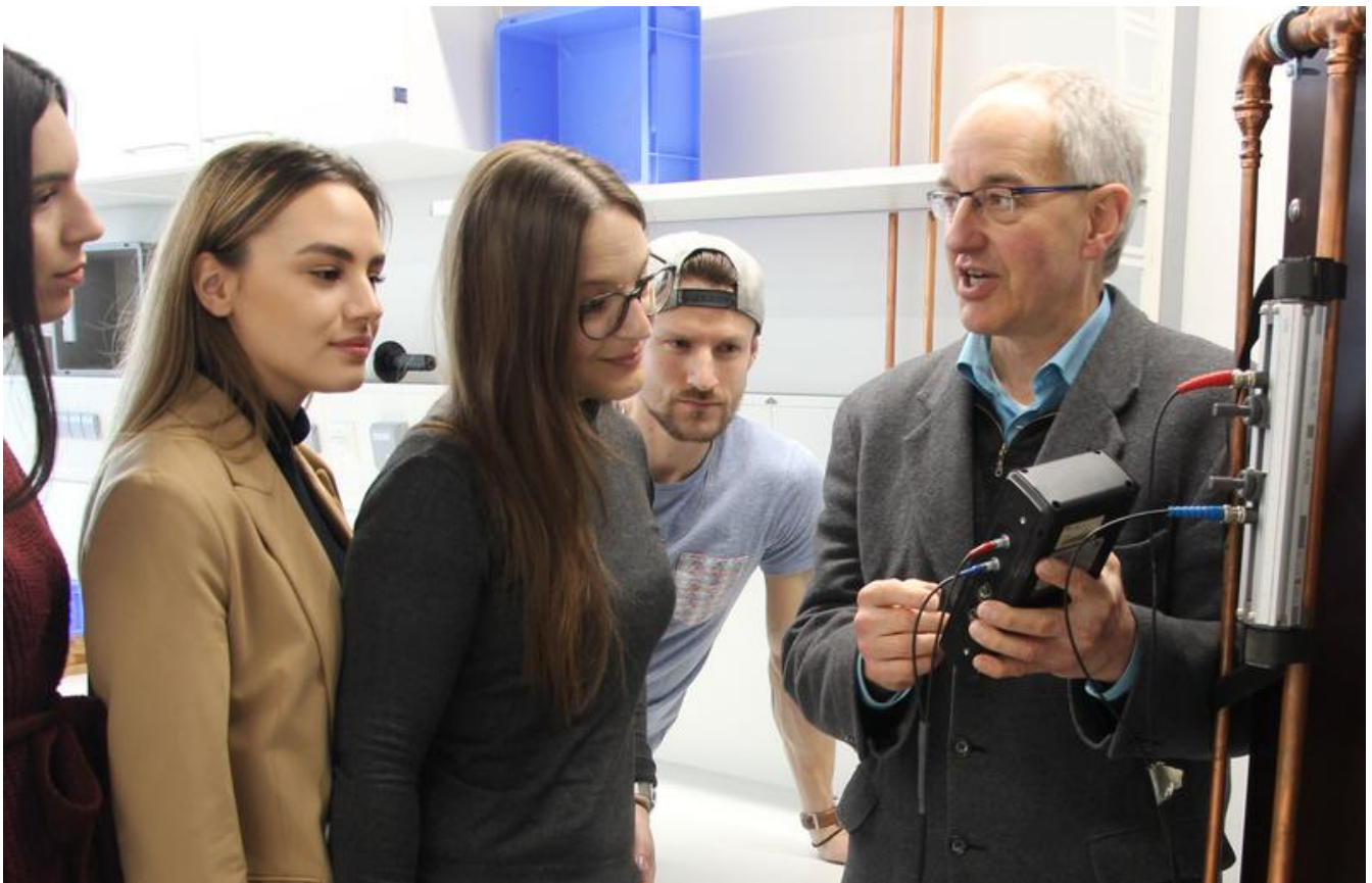
Prof. Hans-Martin Seipp erläutert ein Prüfsystem zur Messung der Strömungsgeschwindigkeit in Trinkwasserleitungen. Foto (TH Mittelhessen/Armin Eikenberg)
